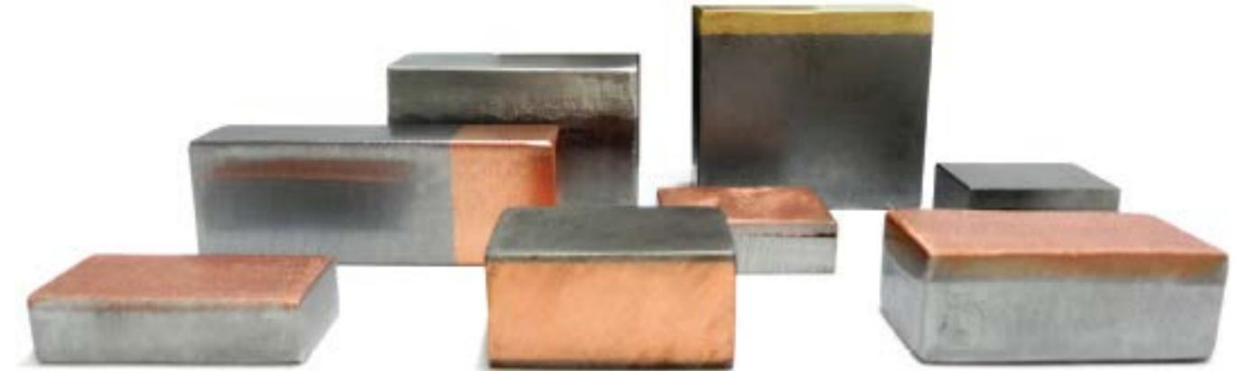
Solda por Explosão é o processo através do qual dois metais são unidos pelo impacto gerado por uma explosão, dispensando agentes intermediadores e aplicação de calor (aquecimento). O resultado é uma ligação metalúrgica de alta pureza e resistência.
